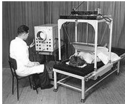
Figura 2: Escáner con bolsa de agua [2].
