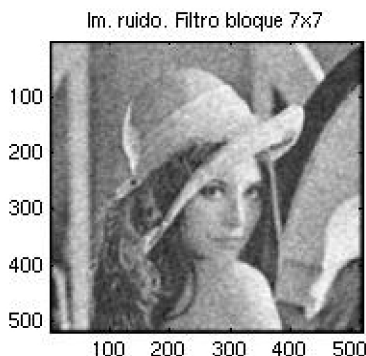
Figura 6: Imagen con ruido suavizada usando un filtro de bloque de 7x7.
